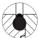
Деталь уплотнения Detail těsnění
